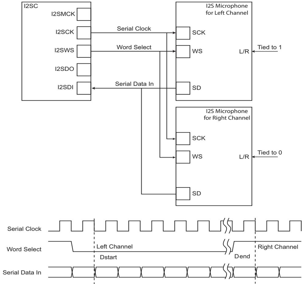
**Figure 30-7. Codec Application Block Diagram**
