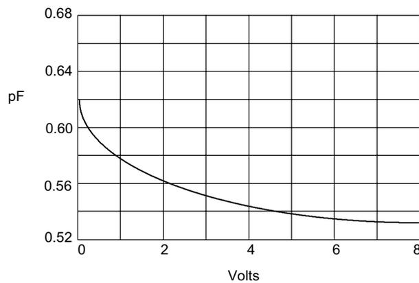
Diode Capacitance - pF *versus*
